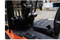
Durch den Kombinationsschalter lässt sich der Sitz nach vorn und hinten verstellen, sodass der Fahrer die optimale Fahrposition wählen kann.
