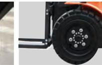
Reifen mit großem Durchmesser für bessere Leistung im Außenbereich und komfortables Fahrerlebnis, optional mit Vollgummireifen.
