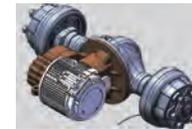
Der Antrieb erfolgt über eine horizontale, fächerförmige, parallel angeordnete Antriebsachse mit großem Übersetzungsverhältnis. Die Batterie befindet sich unten am Fahrgestell, wodurch der Stapler eine hohe Stabilität gewährleistet. Der Antriebsmotor ist ein wartungsfreier AC-Motor. Der lange Radstand (1700 mm) sorgt für höhere Stabilität.
