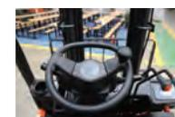
Das U-Design des Lenkrads und die vorne angebrachte Mehrwegeventil-Bedieneinrichtung machen die Bedienung mühelos und komfortabel.
