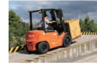
Dank der Feststellbremse mit Ratsche kann der Gabelstapler ohne Sicherheitsbedenken an einer Steigung von 15 % bleiben.
