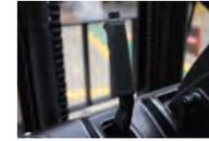
Der Stapler verfügt über eine Feststellbremse mit langem Hebel und Ratsche für eine einfache Bedienung.
