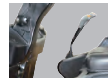
Hydraulischer Bediengriff auf der rechten Seite.
